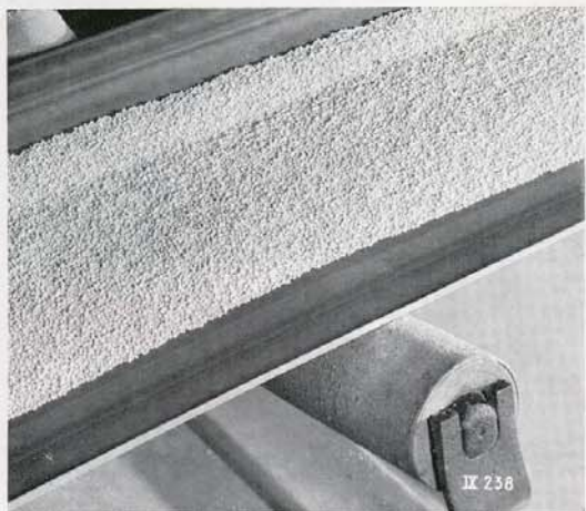
IX 238 Granulado ya cribado y con superficie lisa y resistente a la presión
