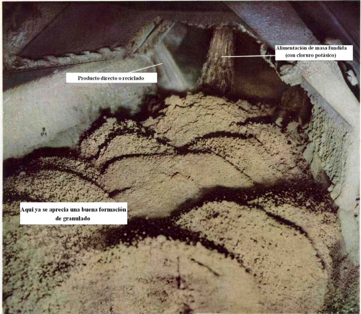
La figura muestra un granulador de doble eje para una producción de 100 Tn/hora = 25 Tn aproximadamente de granulado terminado y listo para la venta (con circulación de un 300% aproximadamente de material que sería necesario para obtener su consistencia, después de la reducción del contenido de agua desde el 11% inicial al 3.5% final.)
