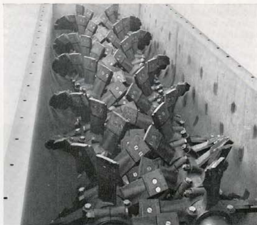
Disposición helicoidal de las paletas en el granulador abierto de doble eje
